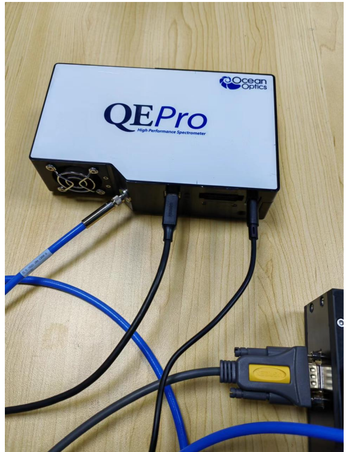
图4 积分球和光谱仪的光纤连接
