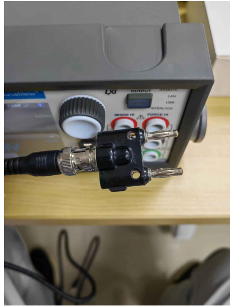
图3 探针台和源表连接
