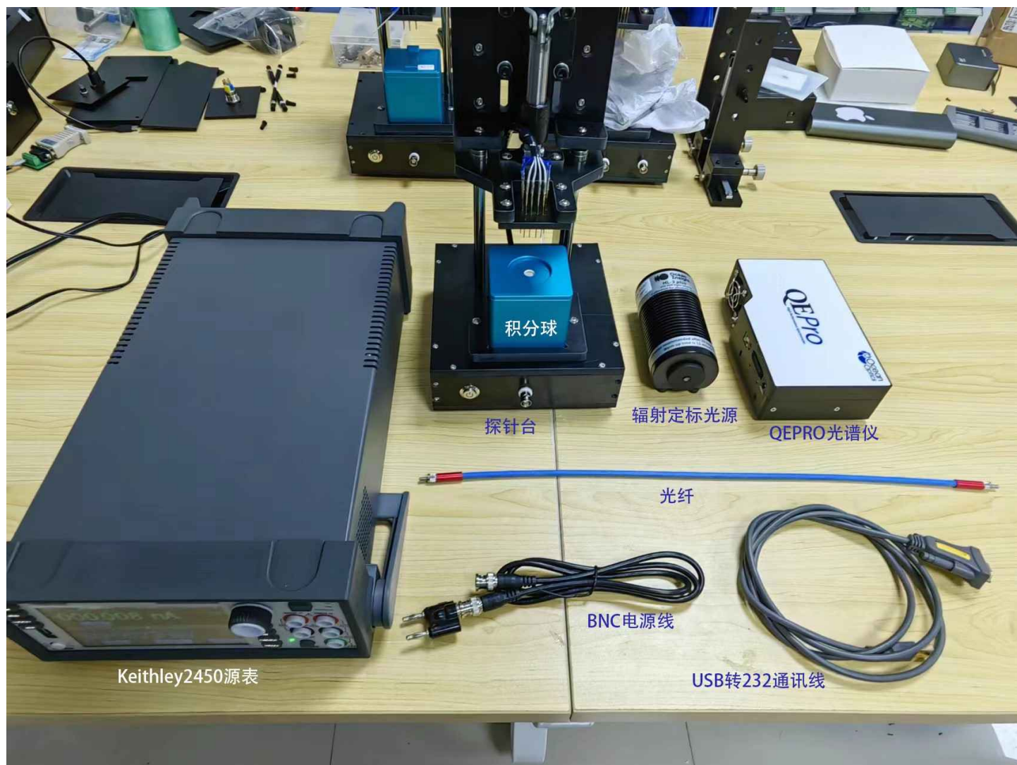
图1 EQE510测量系统组件实物图 and 对应名称
