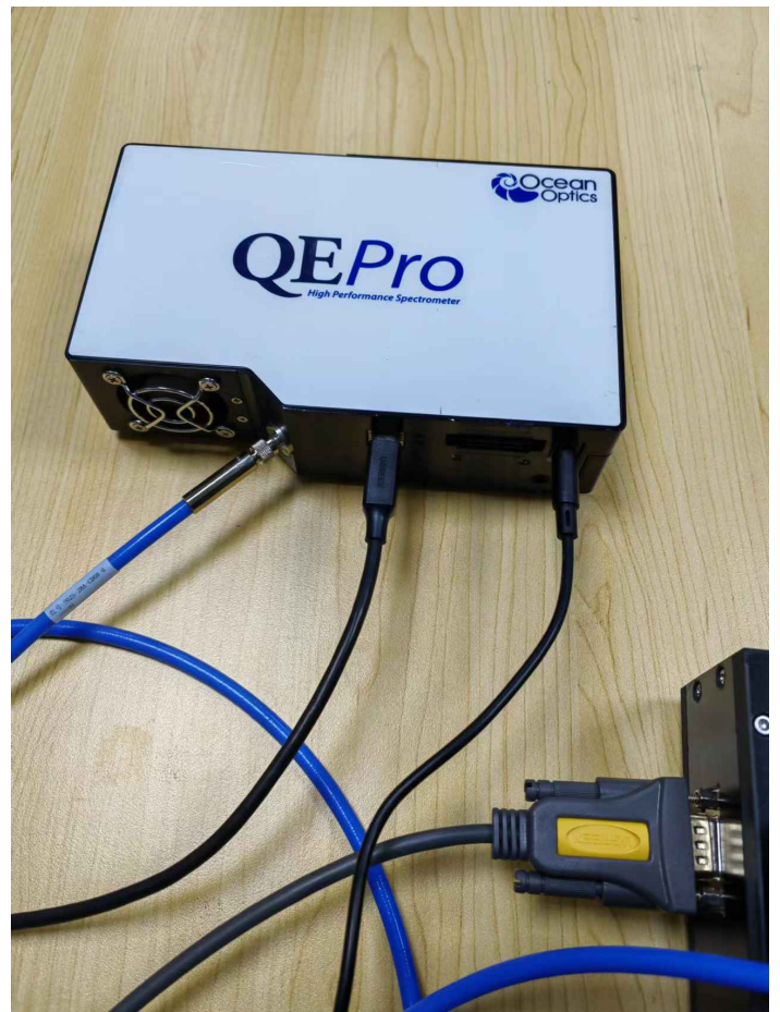
图4 积分球和光谱仪的光纤连接
